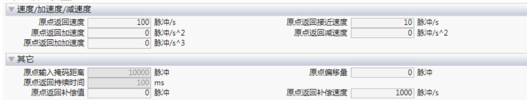
“原点返回设定”：确定“原点返回方法”[欧姆龙 PLC 系列系统对应到回原点的方法，完整需要是 4 个输入信号：“正限位信号”、“反限位信号”、“外部原点限号”和“原点接近信号”。]
